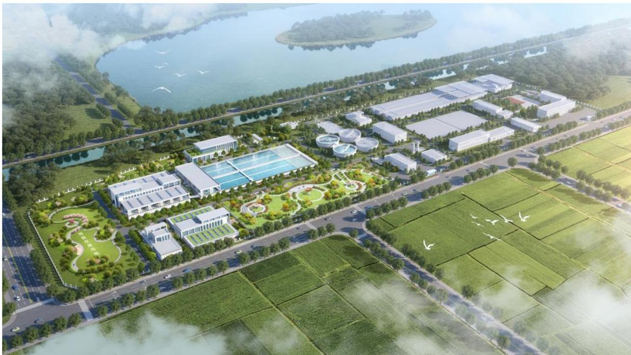
工程配套包含三水厂二期扩建规模20万t/d、二水厂提标改造规模8万t/d，以及配套供水工程中的76km管网和3座加压泵站建设。项目涉及水厂拆建更新、优化改造，打造智慧化现代水厂，提升当地农村供水保障水平。
