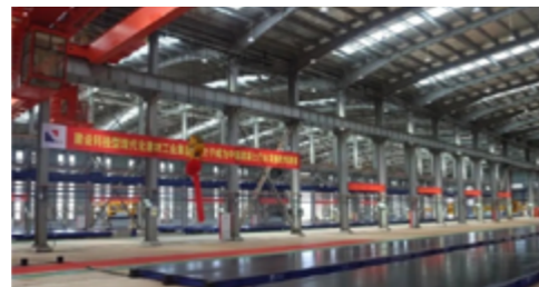
柔性 PC 构件智能生产线
